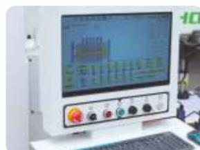
После сканирования штрих-кода на дисплее отобразится распределение сверл
