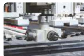
Независимая поперечная торцевая фреза
