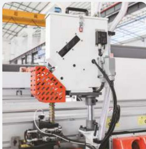
Устройство предварительного расплава клея + функция автоматической загрузки гранул клея + верхняя клеевая ванна (PKQ)
