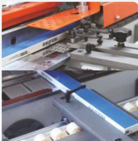
Устройство для подачи узких заготовок
