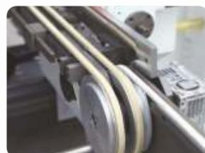
Ленточная автоматическая подача заготовок
