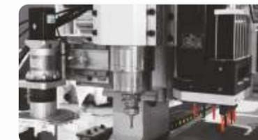
Шпиндель 12 кВт с водяным охлаждением и автоматической сменой инструмента
