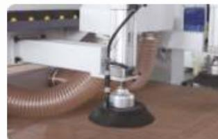
Механизм захвата плит на вакуумных присосках
