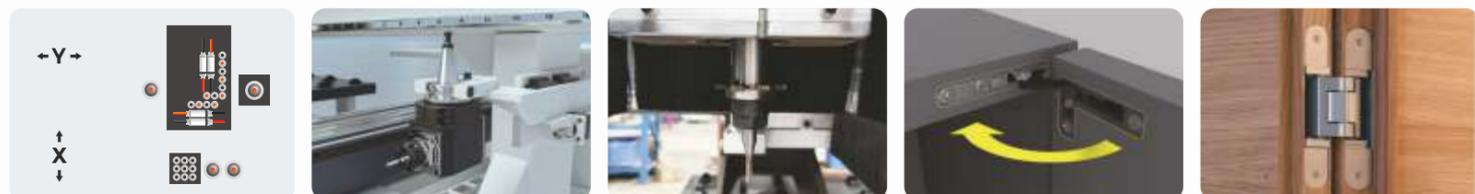
Схема расположения рабочих групп    Независимая торцевая фреза    Комбинированный фрезерный шпиндель и пазовальный диск (Запатентованная технология)    Обработка пазов под петли    Обработка пазов для скрытых петель
