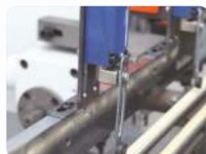
Датчик автоматического позиционирования заготовок в рабочей зоне
